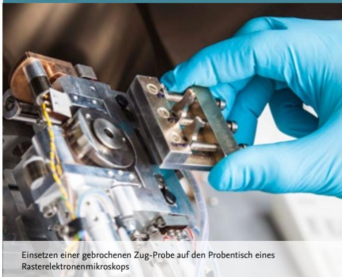
Einsetzen einer gebrochenen Zug-Probe auf den Probenstisch eines Rasterelektronenmikroskops
