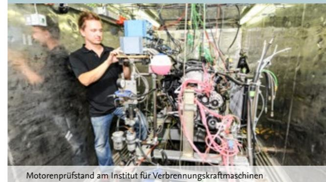
Motorenprüfstand am Institut für Verbrennungskraftmaschinen
