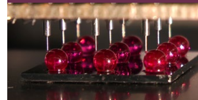
Messung mit einem Mikro-Koordinatenmessgerät
