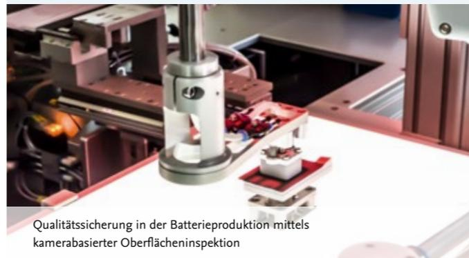
Qualitätssicherung in der Batterieproduktion mittels kamerabasierter Oberflächeninspektion
