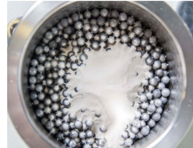
Zerkleinern von Substanzen in einer Kugelmühle
