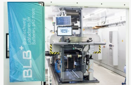
Die Pilotanlage zur Trockenbeschichtung inklusive Trockenraum und Laborinfrastruktur.
