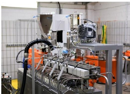
Impressionen aus dem Technikum – Extruder für die kontinuierliche Depolymerisation
