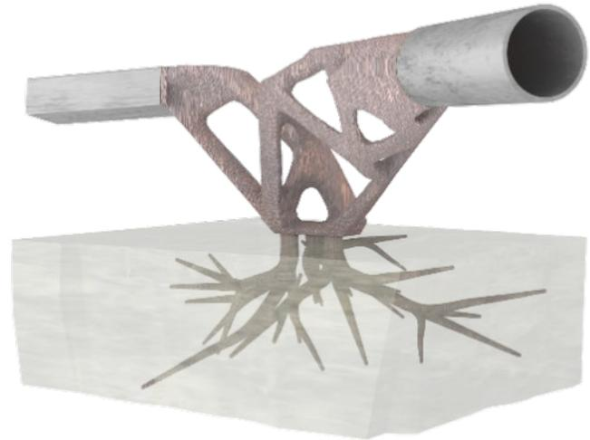
3-D gedruckter Knoten als Verbindungselement im Stahlbau
