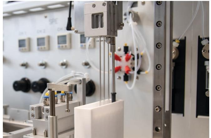
Liquid Handling System zur schnellen Charakterisierung von Probenmaterial.
