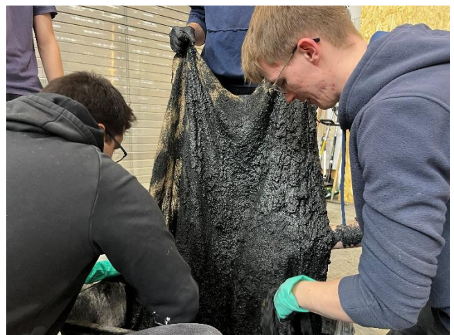
Abbildung 2: Betonage des Pflanzekohlebeton / Foto: Moritz Job
