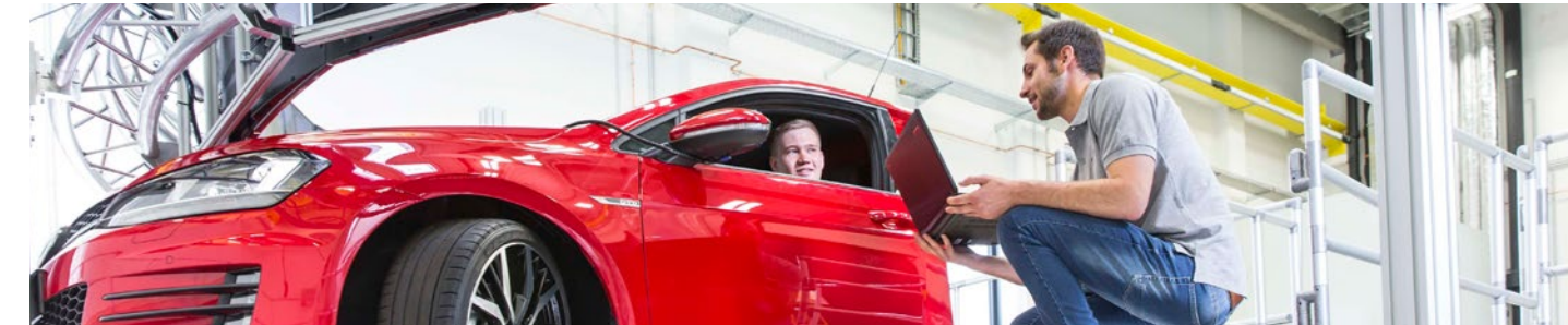
Der Gesamtfahrzeugsimulator im NFF-Technikum ermöglicht nicht nur die Erforschung von Fahrzeugregelsystemen, sondern auch von Fahrerassistenzfunktionen und Funktionen des automatisierten Fahrens. Foto: Christian Bierwagen/TU Braunschweig
