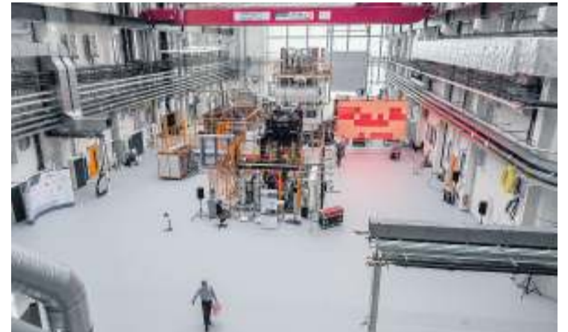
Blick in die Open-Hybrid-Lab-Factory in Wolfsburg. In der Mitte stehen zwei Pressen. In den seitlichen Räumen sind unter anderem Labore untergebracht.
