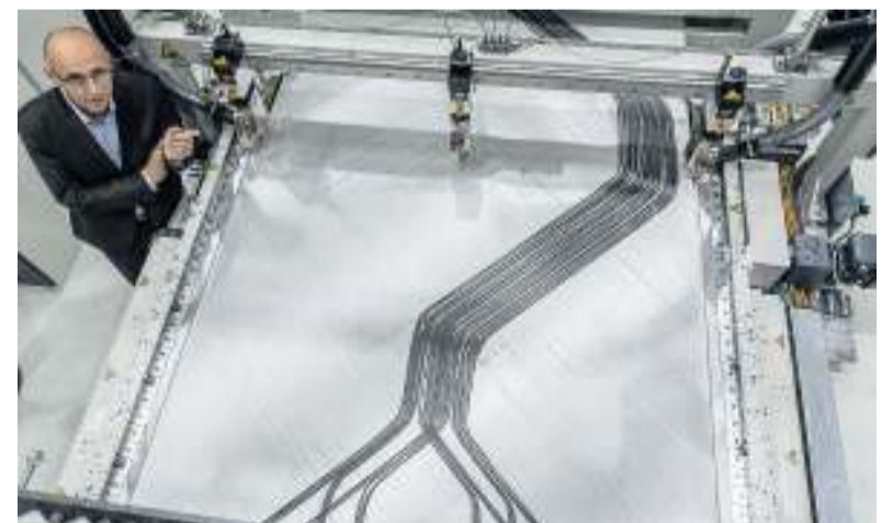
Armin Plath, stellvertretender Vorsitzender der Open-Hybrid-Lab-Factory, steht an der Maschine, die Glas- und Carbon-Fasern legt.
