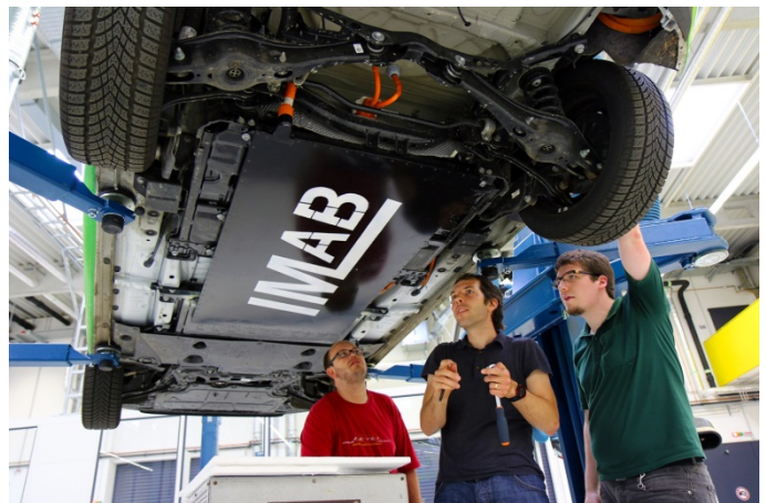
Die Ingenieure Jonas Wussow, Tamás Kurczveil und Tim-Hendrik Dietrich arbeiten unter einem „emilia“-Golf am Induktivaufnehmer, dem so genannten „Pickup“. Foto: TU Braunschweig
