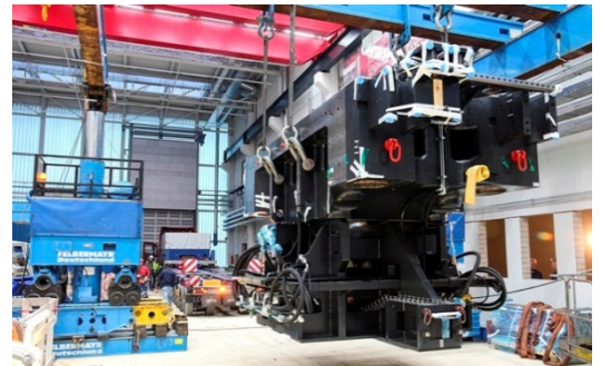
Abladen des Unterholms der Hybridspritzgusspresse im Technikum des „OHLF“-Forschungsneubaus in Wolfsburg. (Foto: OHLF e.V./Detlev Wecke)
