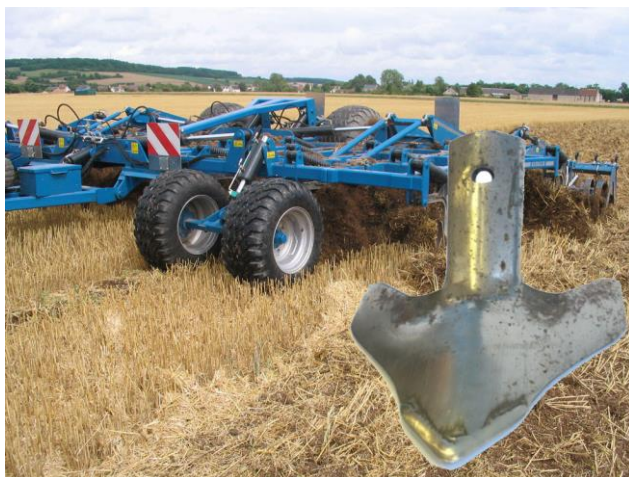
Bild 1: Typisches Verschleißbild eines Grubberschars [Quelle: Köckerling / Wearpoints]
